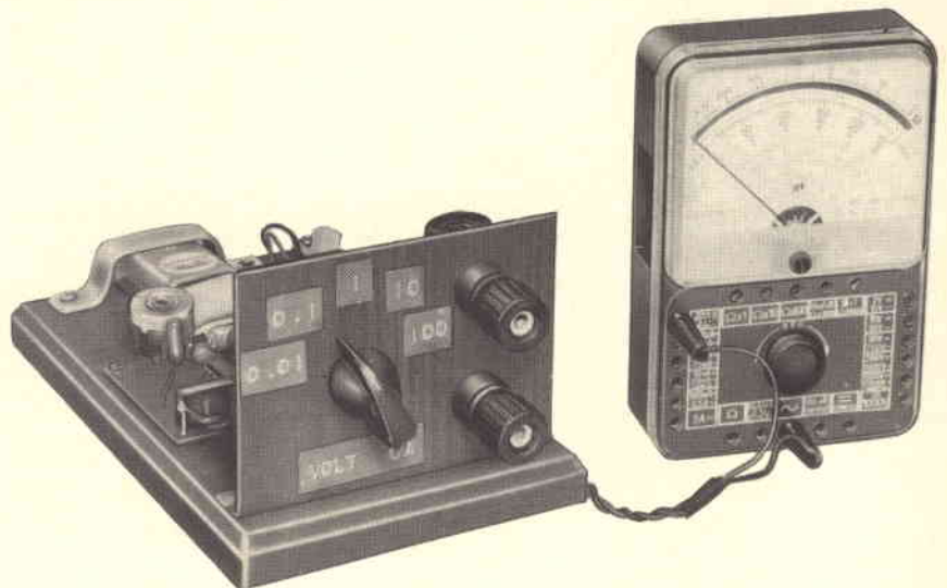
Fig. 1 - Foto frontale del millivoltmetro. Si ha una portata massima di soli 100 V ma lo strumento è prevalentemente destinato ormai alle prove su circuiti di bassa frequenza transistorizzati.
