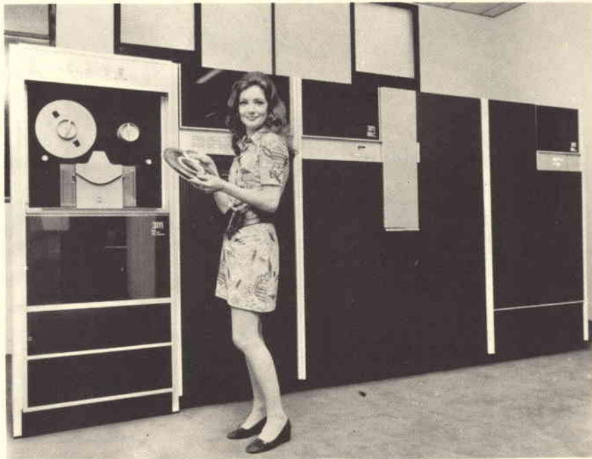
Il nuovo «Electron Beam Recorder» serie F della 3M Italia converte direttamente su microfilm le informazioni prodotte dal calcolatore elettronico. La velocità operativa del sistema è di 20.000 righe di stampa al minuto, circa 20 volte maggiore delle più veloci stampanti collegate agli elaboratori.
