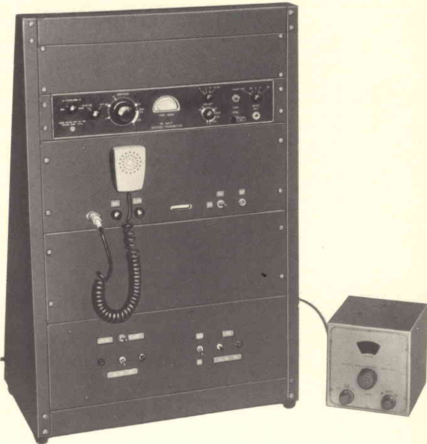
Fig. 5 - Vista di assieme del TX montato sul «rack» standard di piccole dimensioni sul quale sono stati assemblati alimentatore, modulatore e trasmettitore e VFO a lato.
